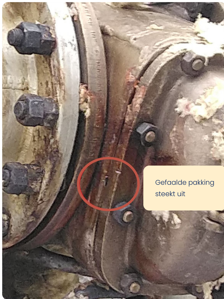
Figuur 6. Gefaalde pakking in afsluiter CA (bron: Westlake dd. 20-11-2024).
