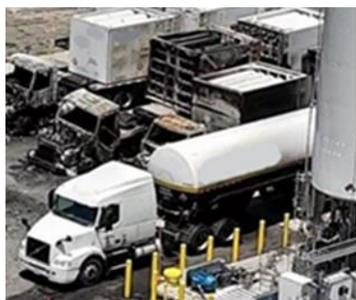
Figuur 2. Schade aan trekker-oplegger
