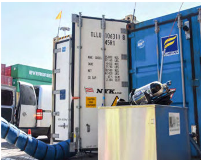
Ontgassing door middel van geforceerde ventilatie. (© Customs Support Safety)
