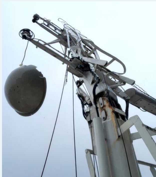
▼ Figuur 26: Schade aan achtermast Eikborg. (bron: Wagenborg)
