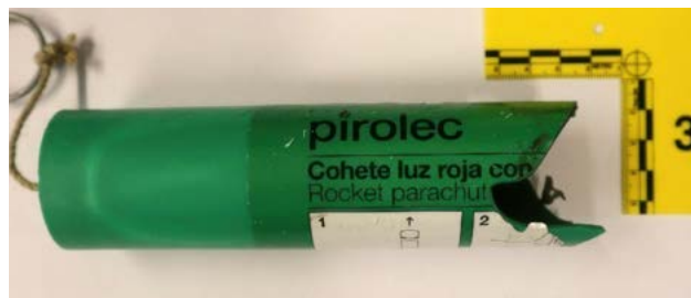
▼ Figuur 10: Veiliggestelde restanten van de geëxplodeerde flare. (Bron: Bontekoning)
